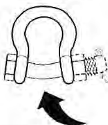
Figura 45 Grillete dañado
