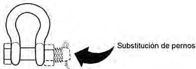
Figura 46 Sustitución de perno
