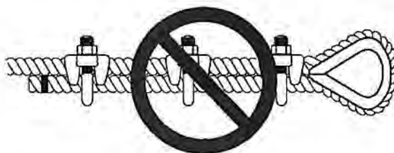
Figura 44 Eslingas fabricadas con grapas para cable
